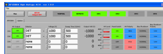
APV3304 VME型4CH 高圧電源ボード 構成例(-1kV x 4CH)
