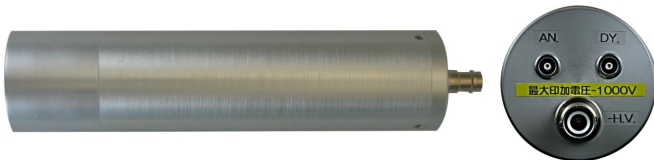
XCE150 (CeBr 3 検出器φ1.5インチ) 外観 (左:側面、右:背面)
