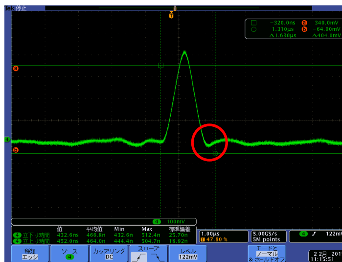
図 16 slow pole zero 調整後
