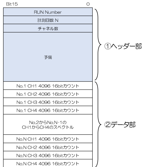
図 20 クイックスキャンデータファイル構造
