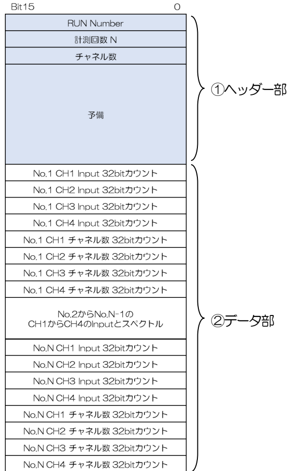
図 21 (オプション) カウント上限拡張 クイックスキャンデータファイル構造
