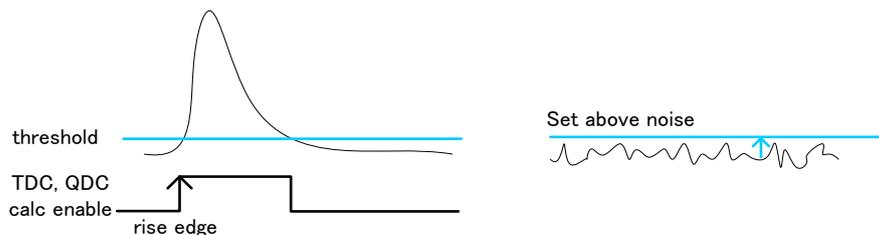
timing type タイムスタンプする際の波形を、CFD 波形または LE 波形から選択します。
