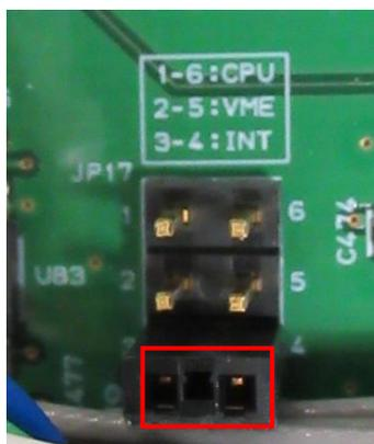
写真 3 内部クロック動作時 (3-4:INT ジャンパ)
