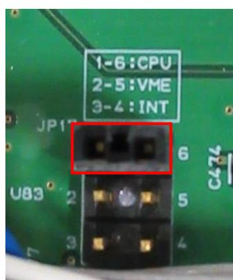
写真 4 外部クロック動作時 (1-6:CPU ジャンパ)
