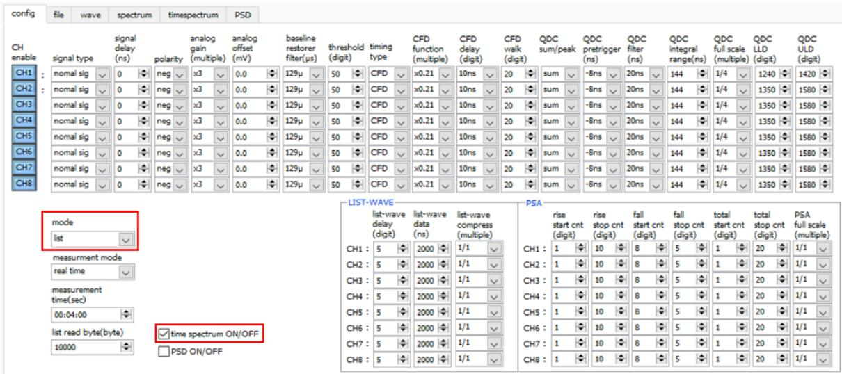
図 35 時間スペクトル計測設定
