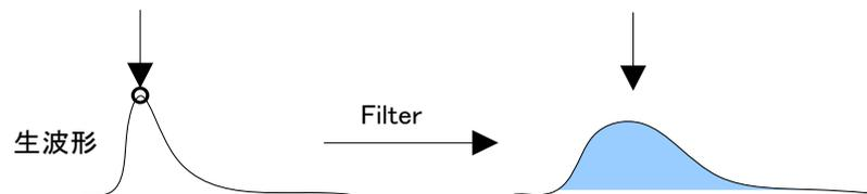
QDC pre trigger (ns) 積分値算出用に波形整形を開始するタイミングを0ns、-8ns、-16ns、-24ns、-32ns、-40ns、-48ns、-56ns、-64nsから選択します。
