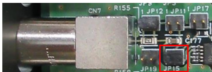
写真 3 トランジスタリセット型設定 (CH7 の場合 JP15 を挿します)
