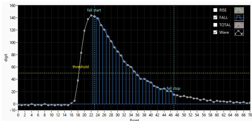
図 8 fall start cnt と fall stop cnt の設定例
