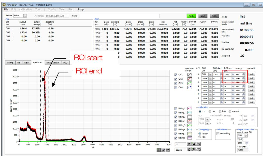
図27 時間スペクトル計測前エネルギースペクトル計測 (エネルギー全範囲)
