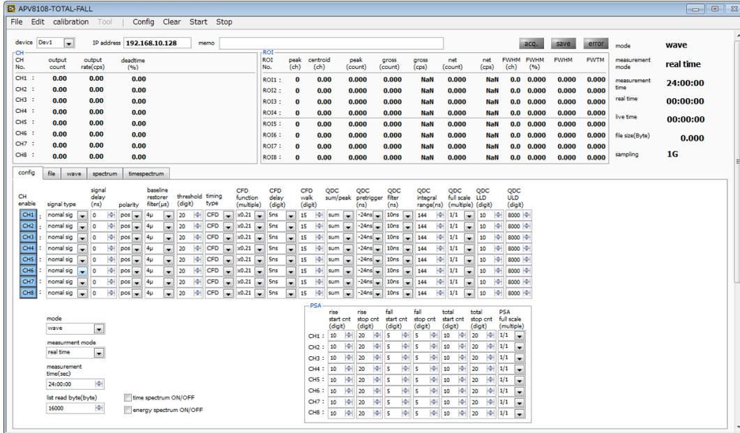
図 15 波行計測設定
