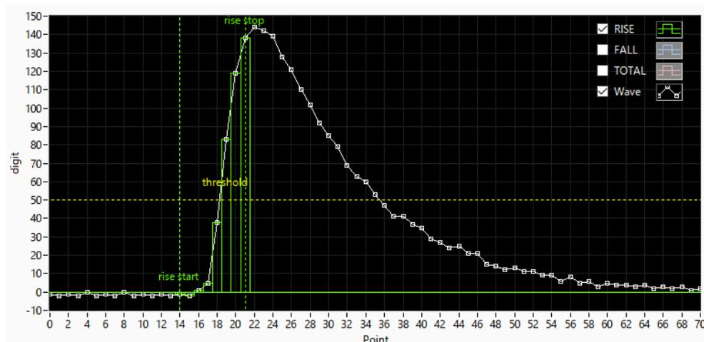
図 7 rise start cnt と rise stop cnt の設定例
