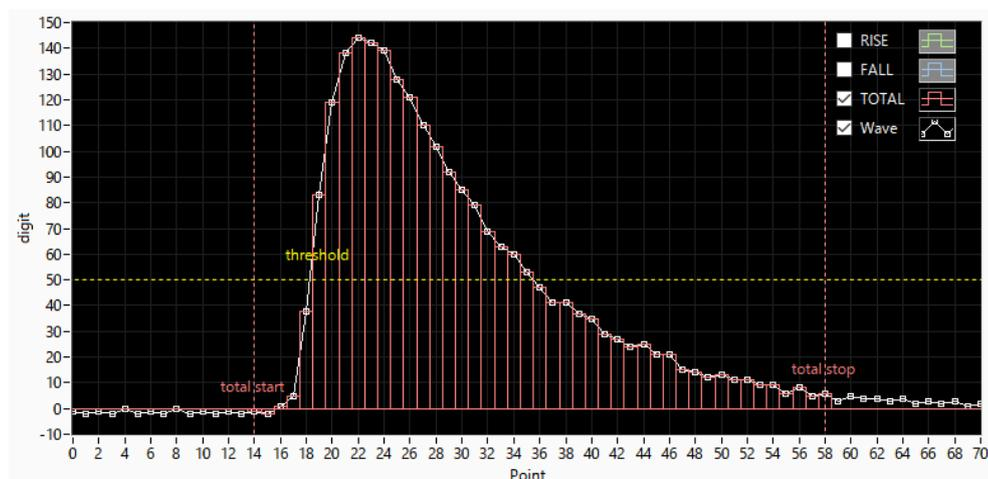
図 9 total start cnt と total stop cnt の設定例
