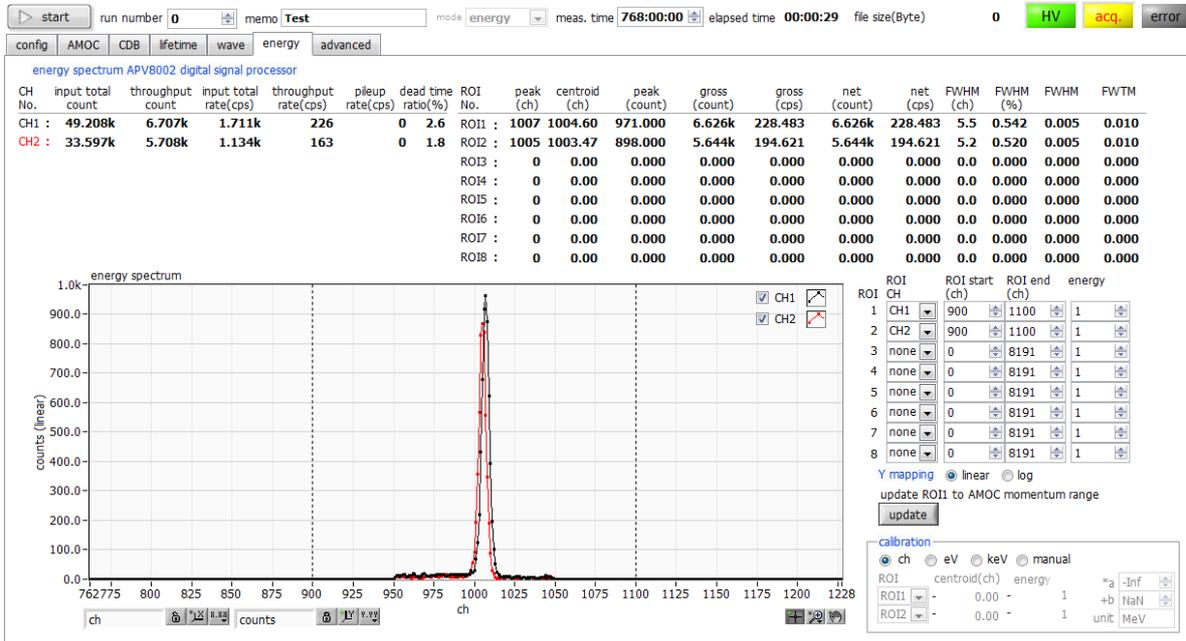
図 37 511keV ピークを囲むように LLD と ULD が設定されたエネルギースペクトル
