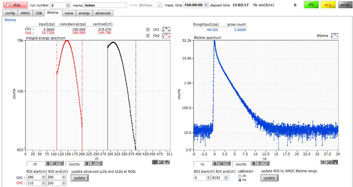
図 9 lifetime タブ (左側 : CH1 : 1275keV ピーク、CH2 : 511keV ピーク、右側 : 寿命スペクトル)
