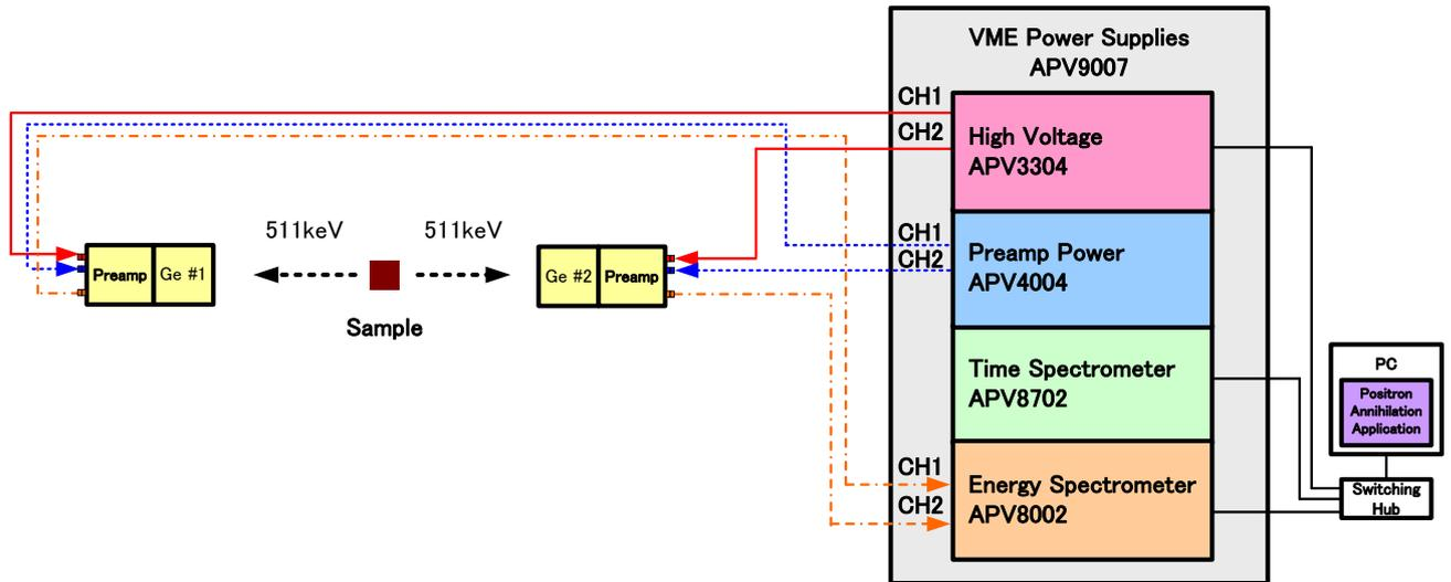
図 2 CDB モード、energy モード接続配線図
