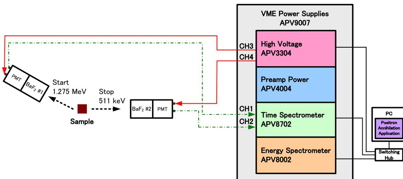
図 39 waveモード接続配線図
