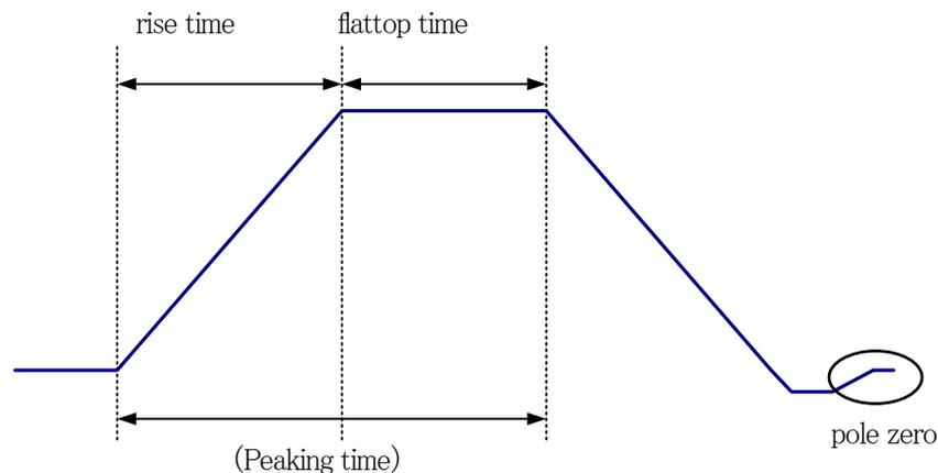
図 14 rise time と flattop time と pole zero
