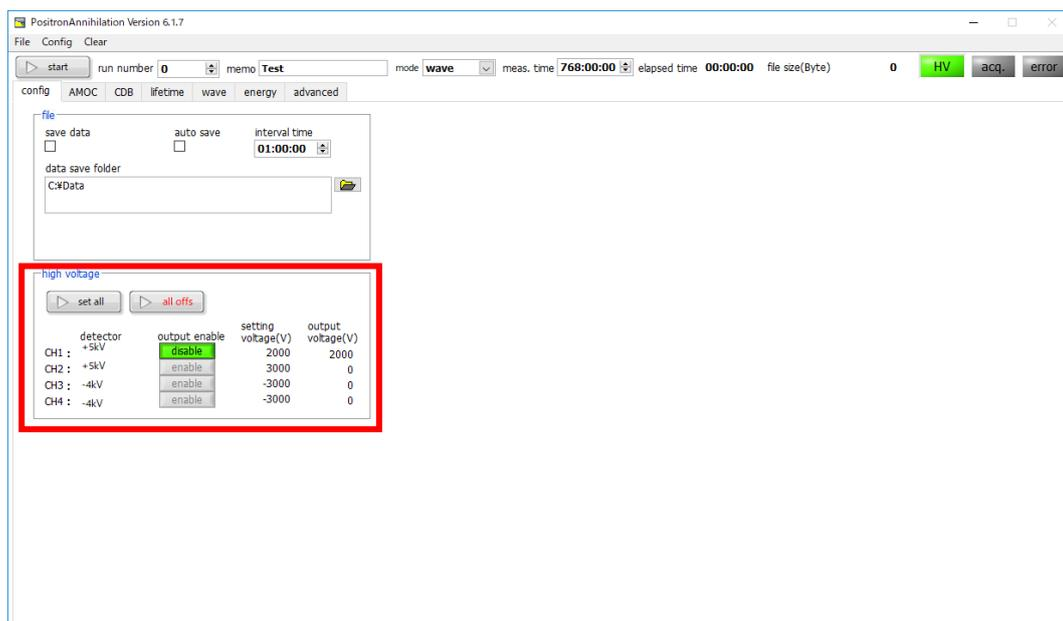
図 23 config タブでの高圧電源設定及び状態表示
