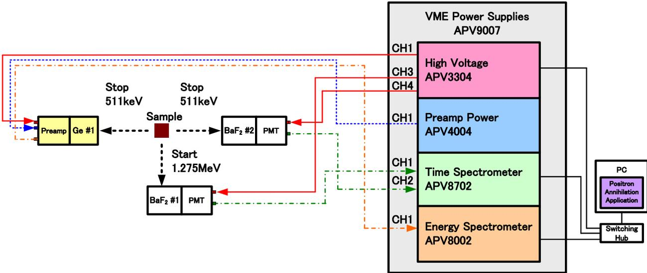
図 54 AMOCモード接続配線図
