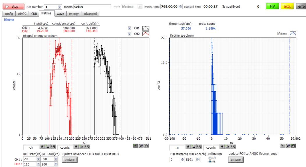
図 51 lifetime モード (threshold、LLD、ULD 調整後)
