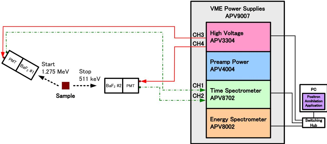
図 47 lifetime モード接続配線図
