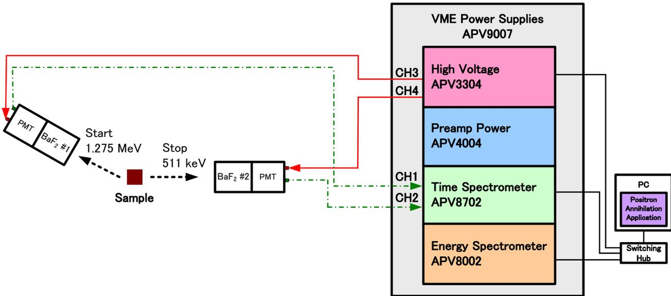
図 1 wave モード、lifetime モード接続配線図
