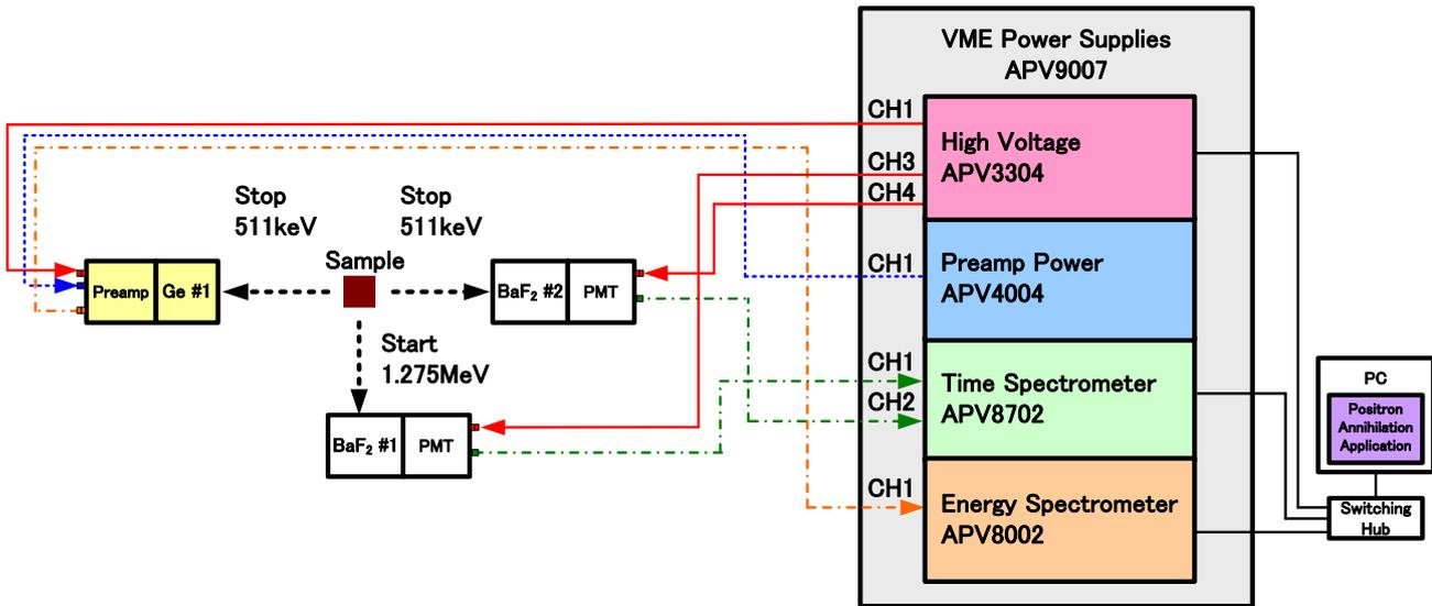
図 3 AMOC モード接続配線図
