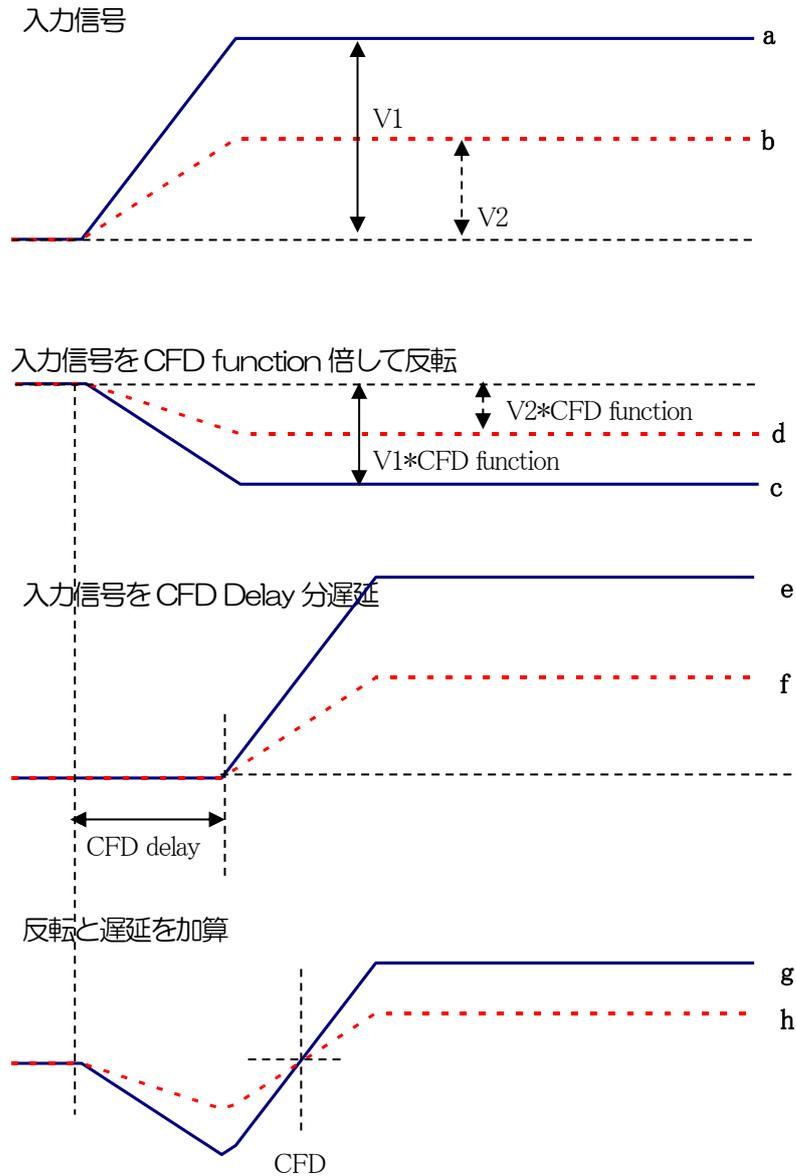
図 17 コンスタントフラクションタイミング (Constant Fraction Discriminator Timing) の考え方
