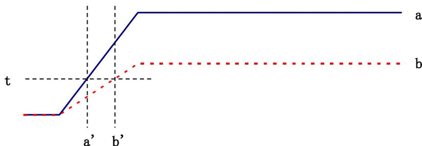
図 16 リーディングエッジ (Leading Edge Timing) の考え方
