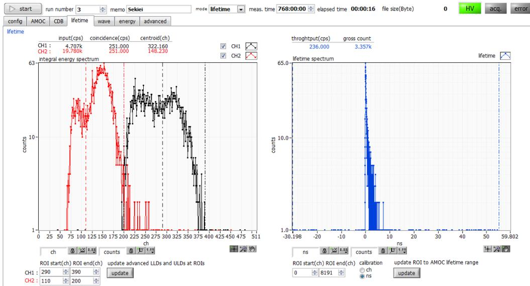
図 50 lifetime モード (threshold 調整後、LLD と ULD 調整前)
