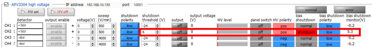
図 19 CH2 バイアスシャットダウン状態
