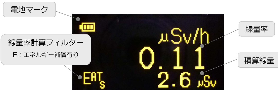
線量率モード（フィルターがエネルギー補償有り自動の場合）
