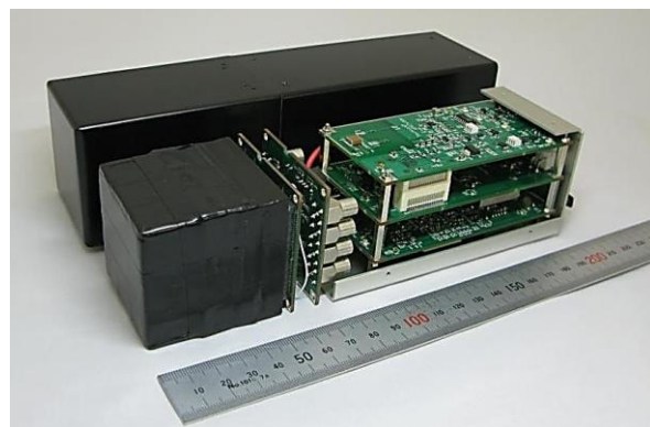
モジュール写真 内部回路(手前) / シールドケース (奥)
