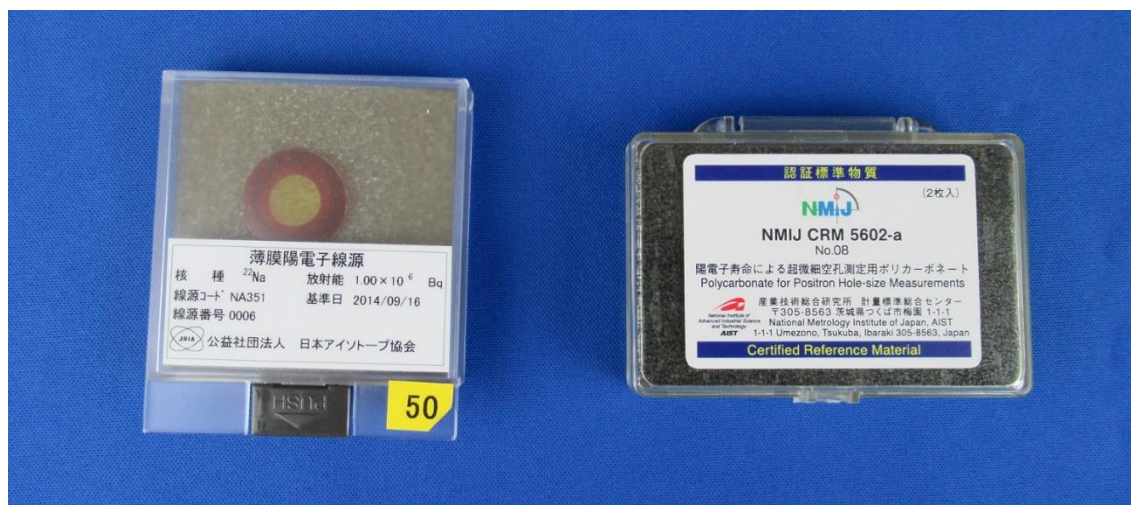
写真③ 左)薄膜陽電子線源 ^{22}\text{Na} 右)標準物質ポリカーボネート
