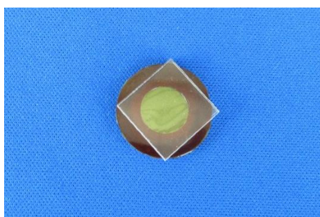
写真④ 標準物質で線源を挟んだ状態(上から撮影)
