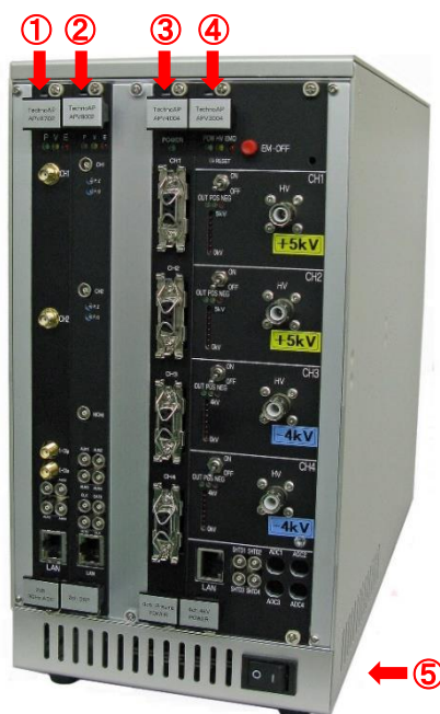
写真② デジタル陽電子消滅寿命／ドップラー広がり測定装置一式
