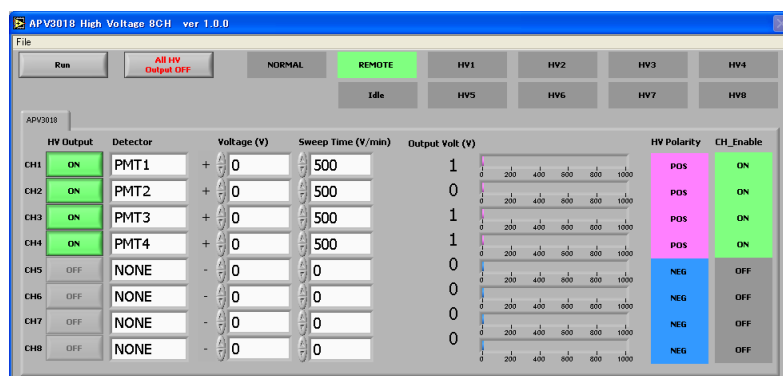
図 10 Voltage(M)に0を設定して、OV程度まで降圧させた状態
