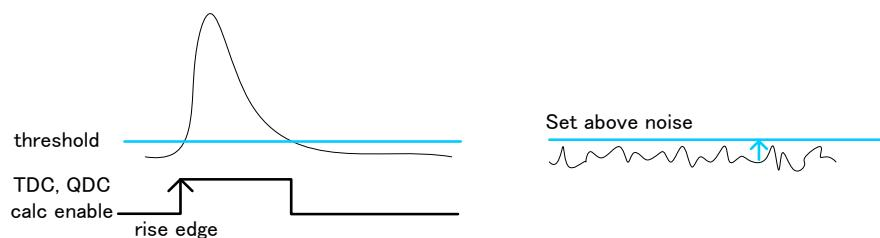
APV8108 及び APV8516 のコンスタントフラクションタイミングは FPGA によるデジタル信号処理にて実現しております。
