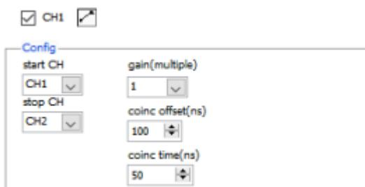
図36 timespectrum タブ内時間スペクトル計測設定
