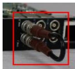
写真3 SYNC-I/O端子接続例
