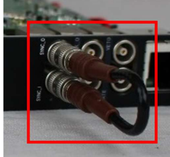
写真 2 SYNC-O 端子と SYNC-I 端子とを相互接続
