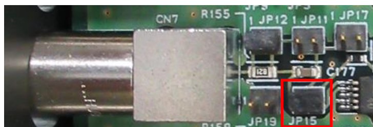
写真 6 トランジスタリセット型設定 (CH7 の場合 JP15 を挿します)
