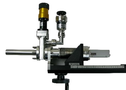
真空1素子シリコンドリフト検出器 XSD50-01WL ST200-GV70-AV34 ゲートバルブ及び駆動機構付き
