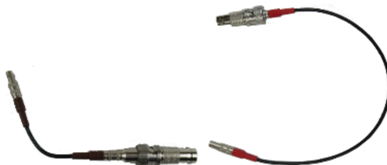
写真3 LEMO-BNC 変換ケーブル例
